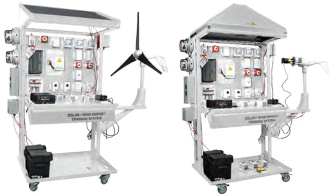
A bancada de treinamento em Energia Solar e Eólica é composta por um sistema completo de formação em energia híbrida. Esse sistema demonstra como turbinas eólicas e células solares estão sendo utilizadas nos mercados de consumo e industriais para, assim, poder complementar as necessidades de energia do mundo. A bancada permite construir um programa
