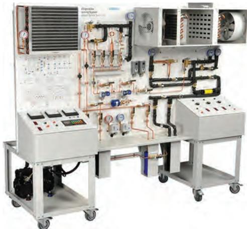
Bancada utilizada para introdução dos princípios e componentes de um sistema de refrigeração, incluindo sistema duplo de evaporação. Além disso, por meio de chaves, é possível inserir falhas no sistema.
