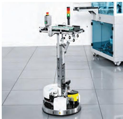
Robotino® é um robô com tecnologia de mobilidade omnidirecional, o que significa que pode se deslocar em qualquer direção, portando sensores, câmera com interface USB e um poderoso controlador lógico. O robô móvel Robotino® pode ser controlado remotamente ou funcionar de forma autônoma, para realizar tarefas pré-determinadas.
