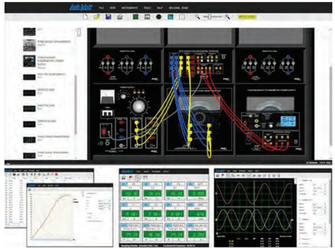
O software LVSIM®-EMS reproduz com muito detalhamento alguns dos principais módulos da linha EMS de eletromecânica da Festo-LabVolt Series. Para os usuários, é uma forma de familiarizarem-se com os mesmos módulos que utilizarão nos laboratórios.
