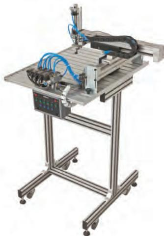
Manipulador Eletropneumático para aprendizagem dos conceitos básicos e avançados de manipulação de peças e objetos. Tecnologias de movimentação de eixos com ou sem haste, fixação para movimentação sujeição de peças por garras e ventosas, controle de posição por sensores digitais e
