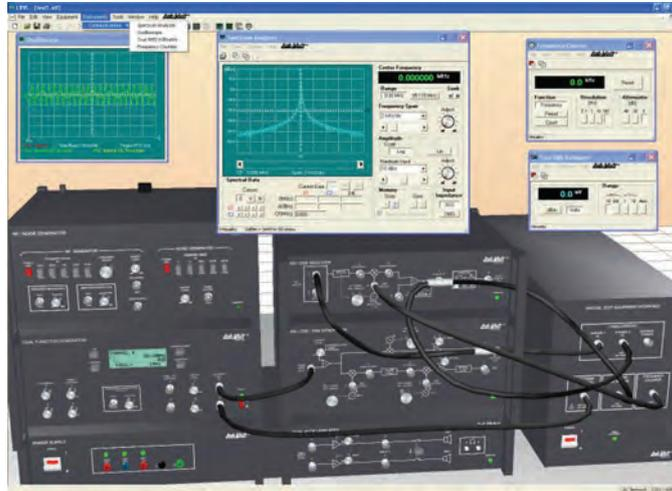
O software permite realizar os mesmos ensaios do sistema de treinamento em comunicações analógicas modelo 8080. O LVSIM<sup>®</sup>-ACOM simula de forma tridimensional o laboratório com os equipamentos da LabVolt modelo 8080. Além disso, o software permite a conexão com o sistema real por meio
