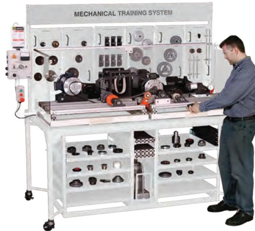
A Bancada de Treinamento em Manutenção Mecânica abrange a manutenção, utilização, manutenção, análises de desempenho, design e solução de problemas dos componentes de unidades de transmissão de energia mecânica. O sistema é dividido em conjuntos, e cada conjunto aborda temas específicos que tratam dos componentes encontrados na indústria. O aprendizado é feito aplicando exercícios e tarefas práticas.
