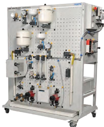
A Bancada de Energia Térmica é um Sistema de aquecimento solar de água para o estudo dos princípios da energia térmica, demonstrando como essa energia pode ser armazenada e as formas de utilização. A Bancada também permite fazer o estudo
