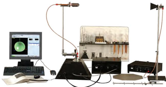
É utilizado para estudos e ensaios com antenas operando em 1Ghz e 10Ghz. O sistema inclui um conjunto de antenas de 1Ghz, um conjunto de antenas de 10Ghz, um gerador de sinal RF, um sistema receptor de sinal, um sistema de aquisição de dados, software de gerenciamento para antenas (LVDAM-ANT) e outros acessórios. O sistema receptor de sinal, consiste em um “posicionador” de antenas atrelado a uma interface de aquisição de dados.
