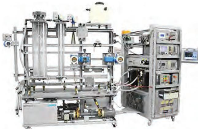
A Bancada de Controle de processos, com foco nas variáveis de pressão, vazão e temperatura apresenta uma ampla gama de processos industriais, bem como os principais instrumentos e dispositivos de controle.
