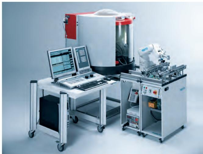
Permite o desenvolvimento de competências e estudo nas áreas de automação, que incluem: robótica industrial; programação e parametrização de máquinas CNC (Torno ou Fresa); esteira para transporte, armazenagem de matéria-prima e separação de produtos acabados; alimentação de máquina CNC e manipulação de peças por meio de robôs
