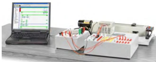
Esta aplicação é destinada para simular processos que envolvam controle de posição e movimentação por meio de motor DC.
