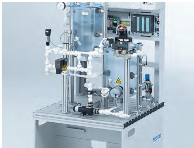
Equipamento para estudo de controle das variáveis de processos contínuos, tais como vazão, pressão, nível e temperatura.
