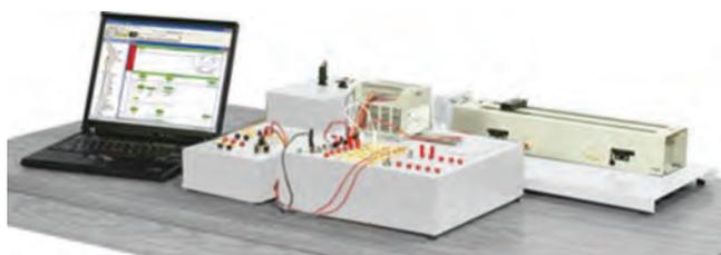
Esta aplicação é destinada para simular processos que envolvam controle de posição e movimentação por meio de motor de passo.
