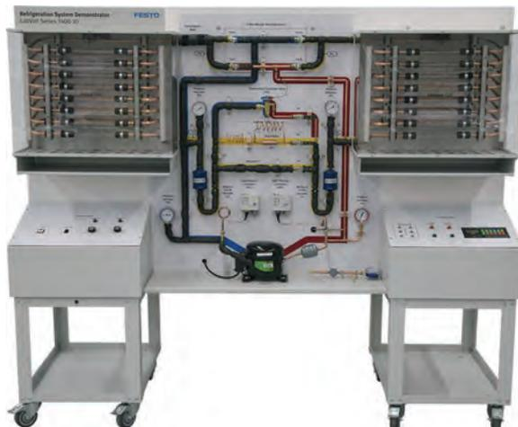
Bancada utilizada para introdução e demonstração dos princípios de funcionamento e componentes de um sistema de refrigeração e bombas de aquecimento. O sistema é utilizado para demonstrar os diferentes estágios do fluido refrigerante
