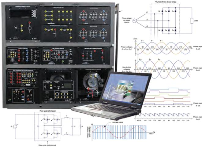
Este Sistema de Treinamento foi desenvolvido com equipamentos modulares associados a uma interface de dados e computador. Assim pode prover um aprendizado de alto nível desde os conceitos básicos da Eletrônica de Potência até os mais avançados. O sistema contempla um módulo Dinamômetro de quatro quadrantes além de módulos para ensino da eletrônica de potência DC, circuitos monofásicos e trifásicos AC e dois tiristores de potência.
