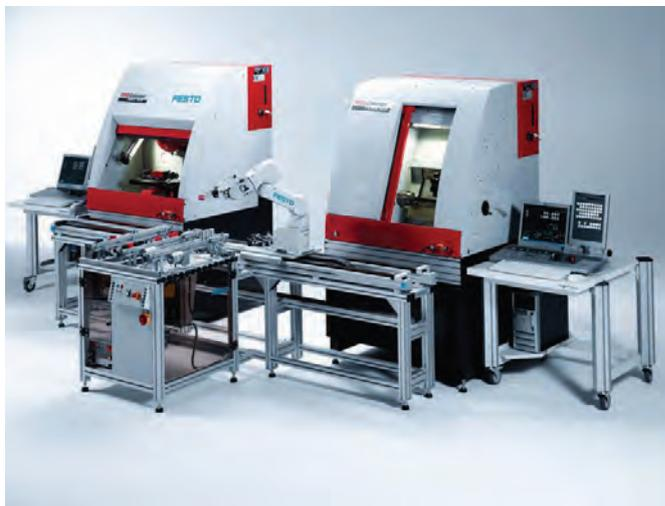
Sistema que combina as características do MicroFMS, ampliando as opções de aprendizado ao mesclar duas máquinas CNC's (Torno e Fresa) integradas por robô de seis eixos, movimentado por esteira comandada pelo controlador do robô, atuando como o sétimo eixo do robô.
