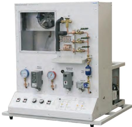
Bancada compacta utilizada para demonstrar operações típicas de sistemas de refrigeração por meio de componentes industriais e comerciais. A bancada inclui condensador com fluido refrigerante (R134a), válvula de expansão termostática, tubo capilar para medições, dispositivo para controle de pressão com display LCD, diversos tipos de sensores, compressor e sistema de segurança.
