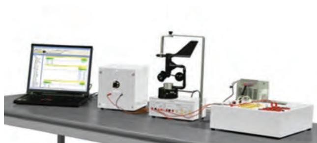
Esta aplicação é destinada para monitorar a velocidade e direção do vento, além de poder controlar a posição da haste de direção do vento. O módulo anemômetro é composto por um motor DC
