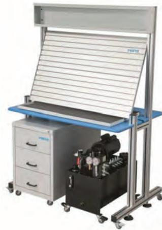
O painel simulador de Hidráulica e Eletro-Hidráulica Festo foi especialmente desenhado para permitir a montagem rápida de circuitos de comando hidráulicos e elétricos, com vistas ao desenvolvimento de ensaios práticos que complementam o aprendizado teórico dos conceitos de Automação Hidráulica Industrial.
