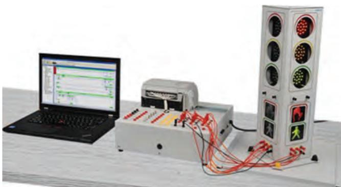
É a solução clássica para iniciantes em estudo de programação de CLPs. Essa solução permite a implementação de controle de semáforo de veículos e pedestres.
